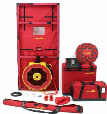
Equipos de una Blower Door. Fuente: Retrotec.
